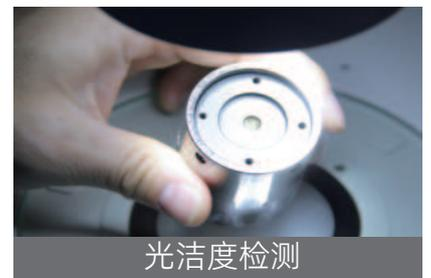
芯飞睿的法拉第隔离器/旋光器，在完成组装后对每一个成品进行检测，其中检测步骤包括对隔离度、透光率和光洁度的检测，以确保产品符合以下要求：
